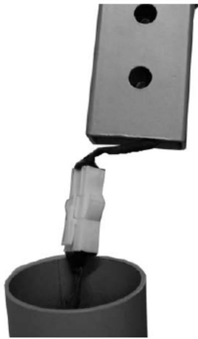
Соедините кабель, вставьте основание руля в раму, предварительно завинтив в него два винта, следите за тем, чтобы не пережать провод.
