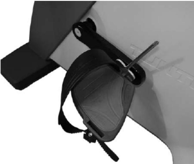
Завинтите педали в шатуны используя гаечный ключ, смотрите на маркировки: L – левая, завинчивается против часовой стрелки, R – правая, завинчивается по часовой стрелке.
