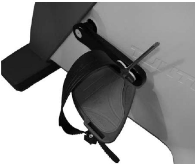
Завинтите педали в шатуны используя гаечный ключ, смотрите на маркировки: L – левая, завинчивается против часовой стрелки, R – правая, завинчивается по часовой стрелке.
