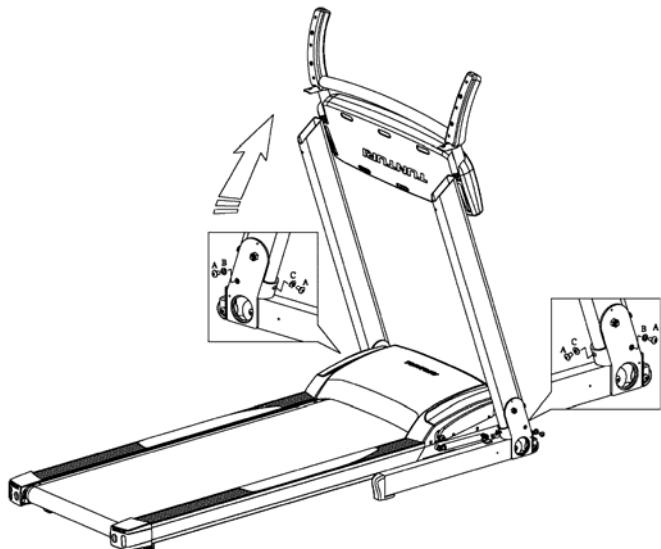
Поставьте компьютер в правильное положение. Используйте шестигранник(E), чтобы завинтить винты (A) с шайбами (C) в отверстиях в верхней части стоек.
